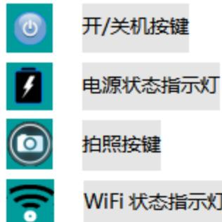
按开/关机键打开探头电源，探头前面的 6 个白光 LED 会亮起，说明探头供电正常。再等待 15s 左右，探头 WiFi 指示灯会亮起，此时就可以用平板电脑通过 WiFi 连接探头了。
