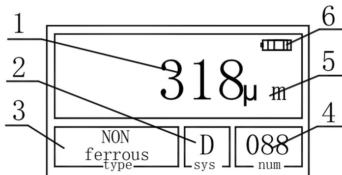
1. 数据显示 2. 测量方式 3. 测头类型指标
