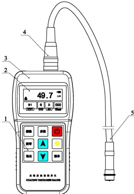
1. 仪器主机    2. 显示屏    3. 键盘    4. 测头插座    5. 仪器测头
